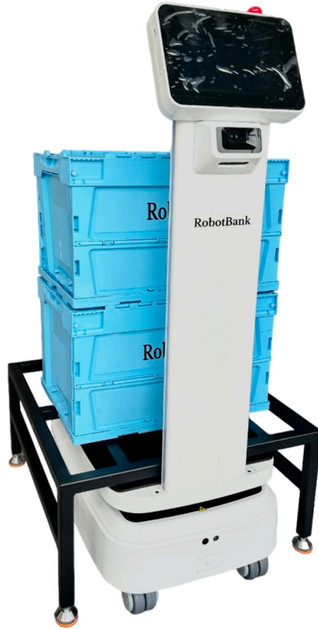
AMR自律走行搬送ロボットStarLift300はStarLift150を発展させ、より重い荷物を運搬するために設計されたハイパフォーマンスなロボットです。最大300kgまでの荷物を効率的に運ぶことができ、大規模な製造ラインや倉庫内での使用に最適です。
