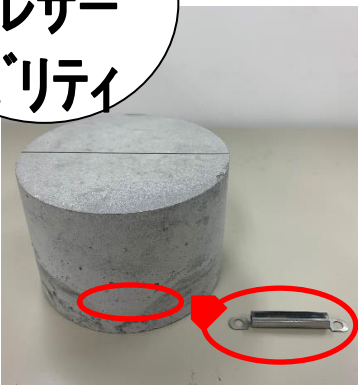
止め穴式パイプ型タグ (取り付け方法:コンクリート埋め込み)
