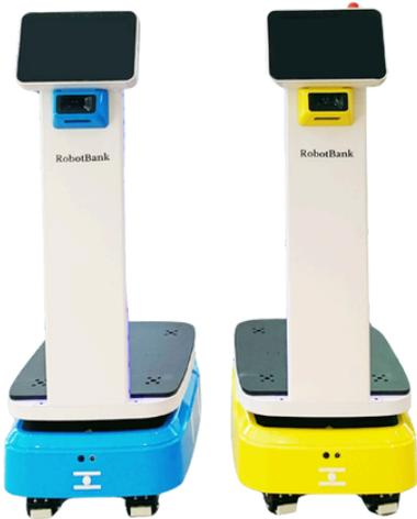
自律走行搬送ロボット(AMR)「StarLift」シリーズは、荷物の自動搬送と、昇降機能による棚(架台)の自動上げ下ろしまでを1台で完結させます。
