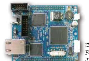
拡張I/O、RS-232C、Ethernet 及びUSBファンクション搭載の汎用CPUボード
