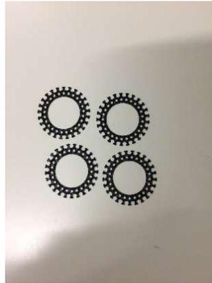
難加工な炭素繊維複合材は、ミーリング（切削）加工もしくはウォータージェット加工が一般的
