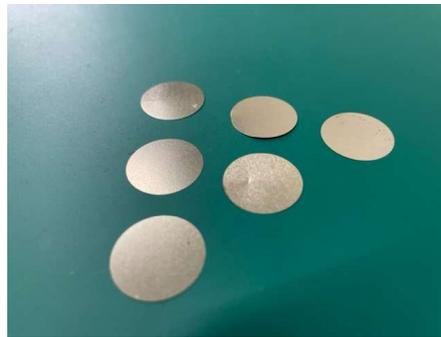
アモルファス合金で構成されたモーターは、鉄損が低く高効率なモーターに適した材料だが、以下の課題がある
