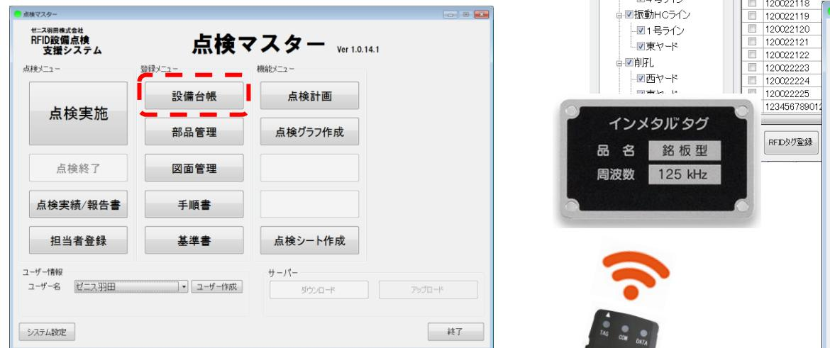
設備に取り付けたRFIDタグを読み込むことにより、対象設備の台帳が表示されます。
