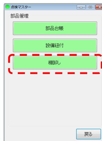
置場用のRFIDタグを読み込むとその棚に登録されている部品一覧が表示されます。
