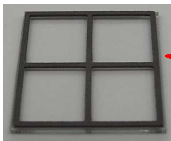
厚膜回路 (□30mm) 最小ライン幅50 \mu m
