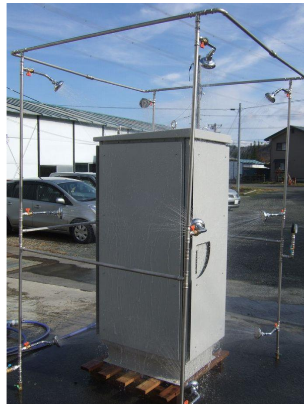
散水試験の様子
