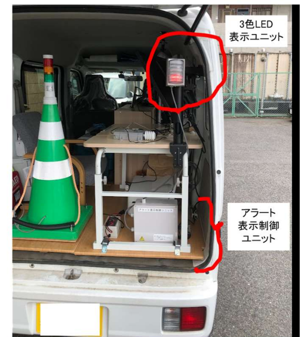
■LED表示ユニット・制御ユニット 設置例
